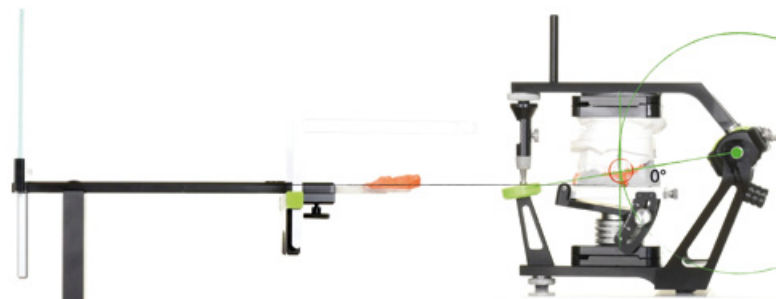
Abb. 13: Ausrichten des Oberkiefermodells anhand des Silikonschlüssels.
